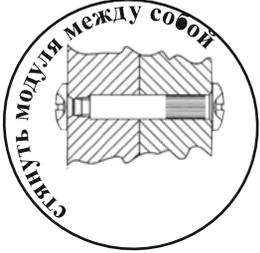
Просверлить отверстия сверлом D5
