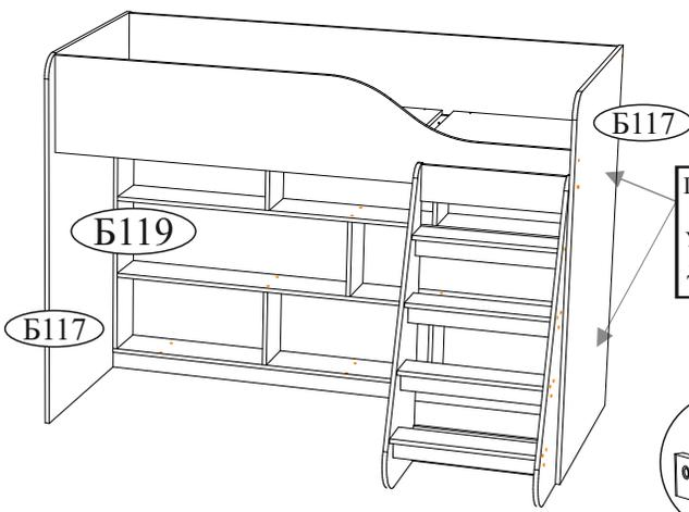
Просверлить отверстия D5 с 2-х сторон
